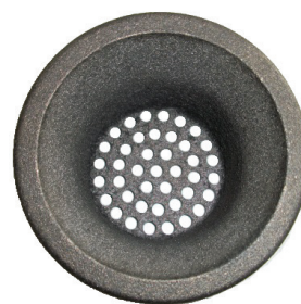
Fig. 13 Ren brännkopp. Inga rester inuti, alla hål rena och synliga.
