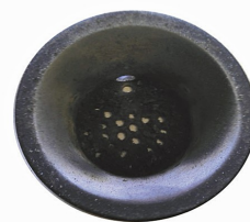
Fig. 14 Brännkopp med hålen täppta av aska. Rengöring är nödvändig.
