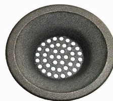
Fig. 13 Ren brännkopp. Inga rester inuti, alla hål rena och synliga.
