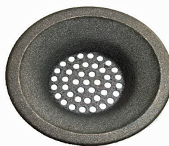
Fig. 13 Ren brännkopp. Inga rester inuti, alla hål rena och synliga.
